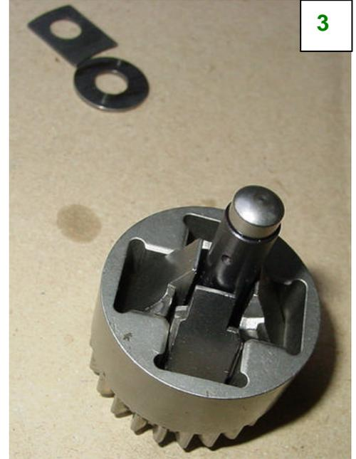
Insérer l'axe puis positionner la plaque de compensation et la rondelle d'appui
