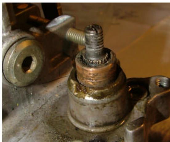
**Démonter les pattes qui empêchent la dépose du couvercle de la PI**
