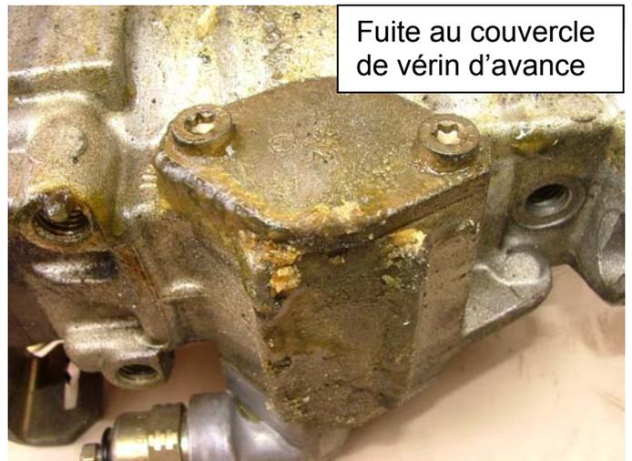
Un grand nettoyage s'impose ! Et pour cela, un simple produit nettoyant semble ne pas suffire, il faudra donc enlever le plus gros en grattant avec une lame, et finir au produit.
