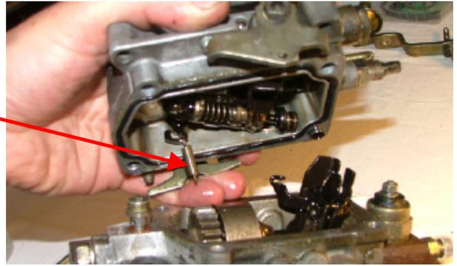
Si le couvercle ne vient pas, c'est simplement parce qu'il y a un méplat sur l'axe du ressort de régulation, qui doit passer dans la fente du levier de tension (Voir ci-dessous). Pour dégager le couvercle il sera conseillé de le soulever, et d'enfoncer simultanément l'axe du levier de commande
