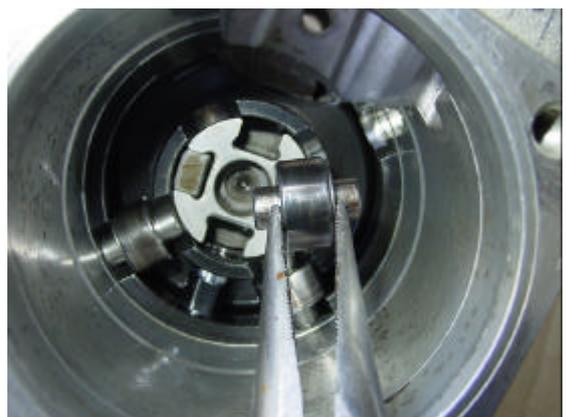
**Retirer l'étrier, puis la goupille d'arrêt, et enfin l'axe de réglage**
