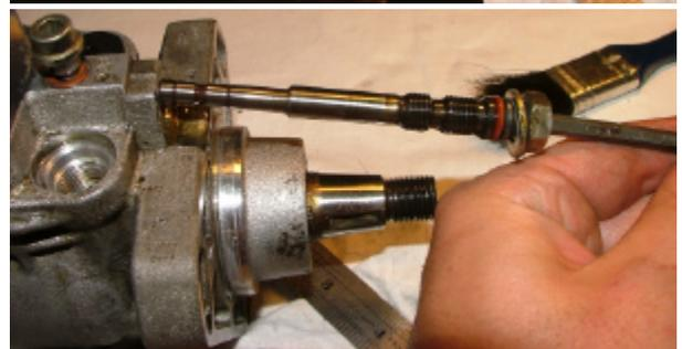
Démonter les 2 vis à téton qui tiennent le levier de tension (ou de réglage). Il s'agit de vis spéciales, donc pour les démonter, 3 solutions :
