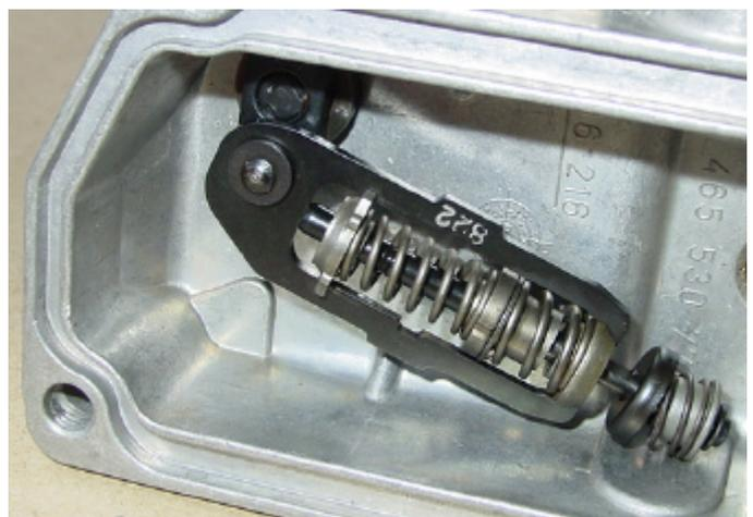
Repérer et démonter la vis de réglage du débit pleine charge, et changer le joint
