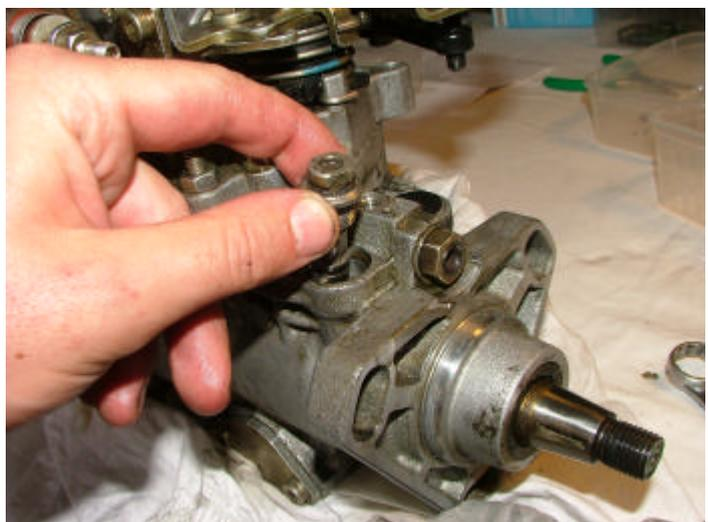
**Maintenant, démontons le levier de commande d'accélérateur :**
