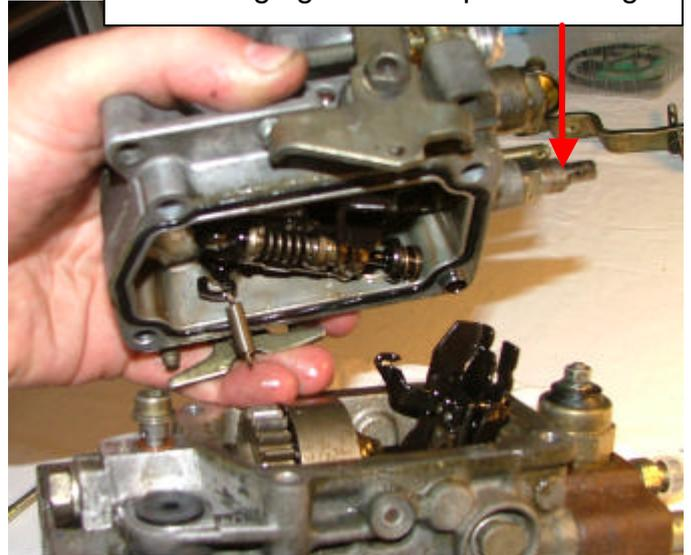
Mettre en place le ressort et les cuvettes de ressort, puis le levier de commande d'accélérateur suivant le repérage effectué au démontage
