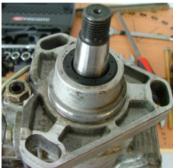
Changer les joint des raccords de refoulement si nécessaire
