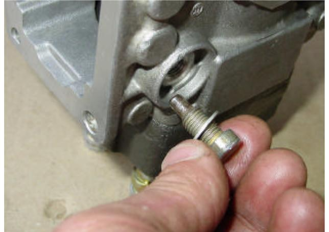
Démonter la plaque de recouvrement du vérin d'avance
