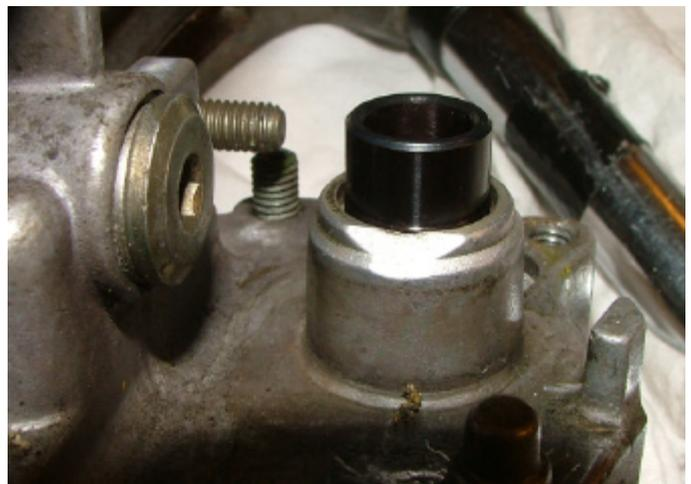
Remettre en place l'axe d'accélérateur dans la bague montée précédemment avec son « ressort de régulation charge partielle »
