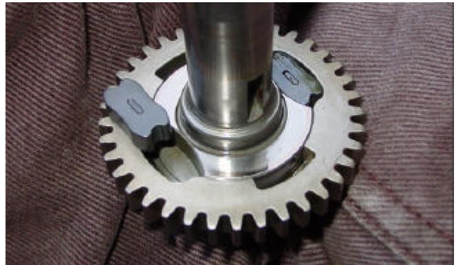
**Mettre en place la rondelle de glissement et la clavette**
